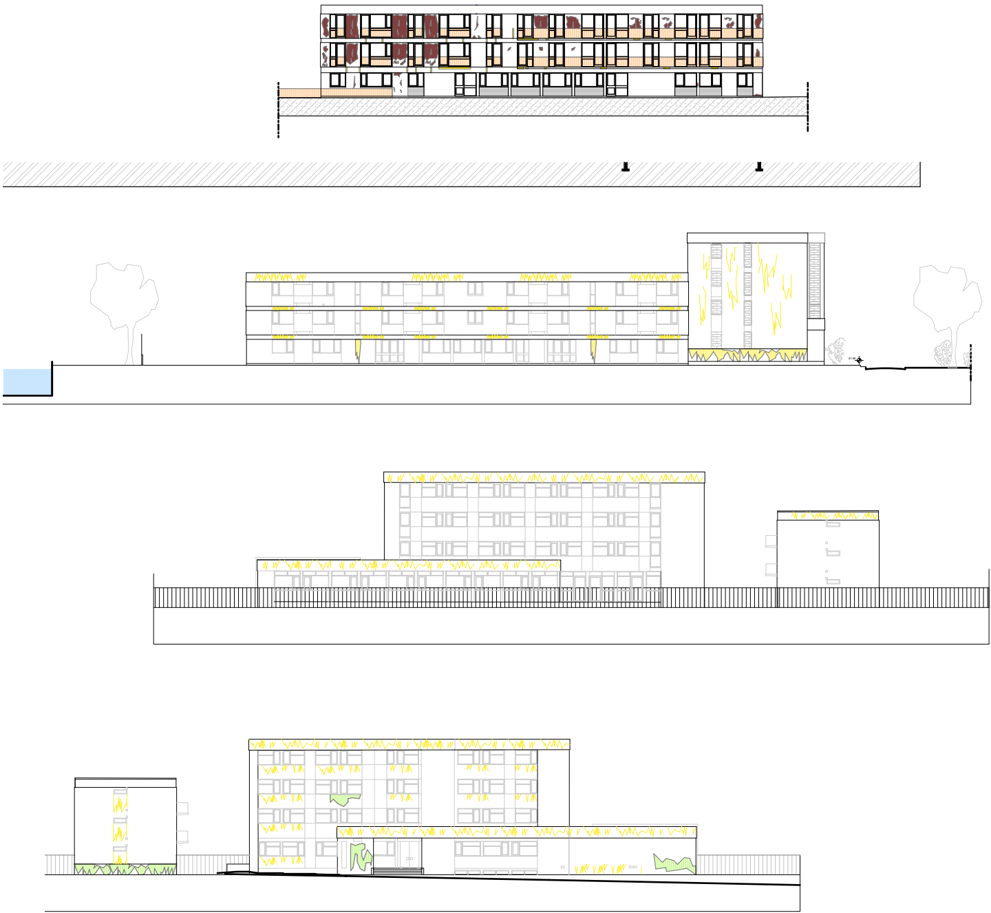
12. Elevations représentant l'état sanitaire des façades des logements de fonction
