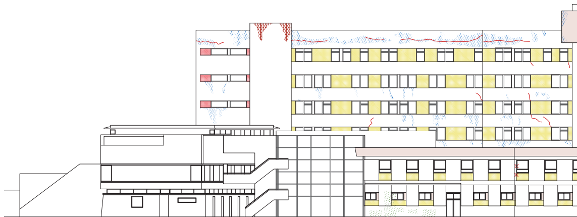
Fig 34 : Etat sanitaire de la façade nord
