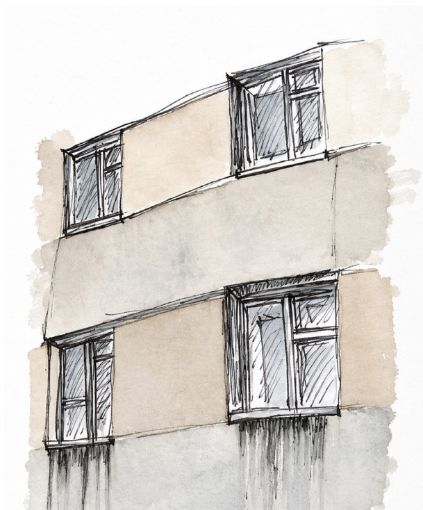
Traces d'humidité sous les menuiseries
