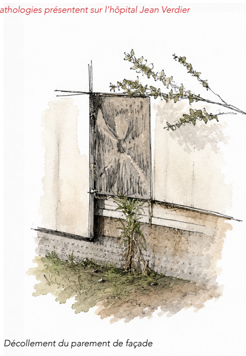
Fig 36 : Relevé dessiné de pathologies présentement sur l'hôpital Jean Verdier
